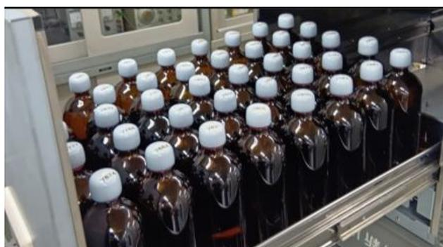
第5図 キャップタグの装着と1BOXへの500ml容器40本実装
